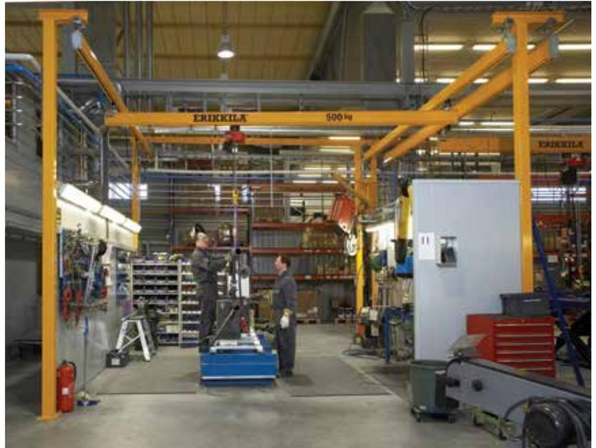
Skräddarsydda lösningar med hjälp av fristående konstruktion.
