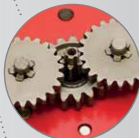
Kothjul och drivaxel är lagrade på 2 st nållager.
