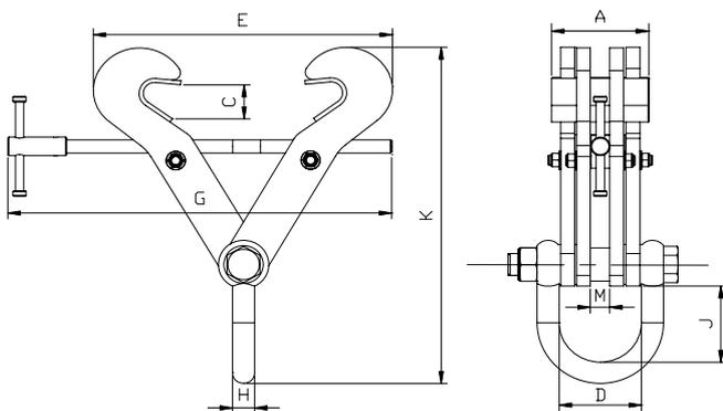
BALKKLÄMMA/BEAM CLAMP - Model S - Fixerad Gripklo / Fixed Jaw
