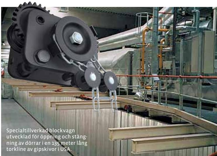
Specialtillverkad blockvagn utvecklad för öppning och stängning av dörrar i en 135 meter lång torkline av gipskivor i USA.
